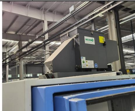
机加工设备配套油雾净化器
