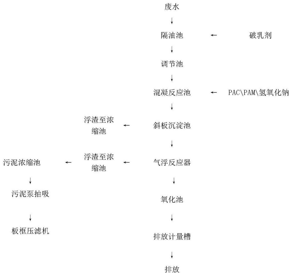
图 2-3 厂区污水处理站生产工艺流程图
